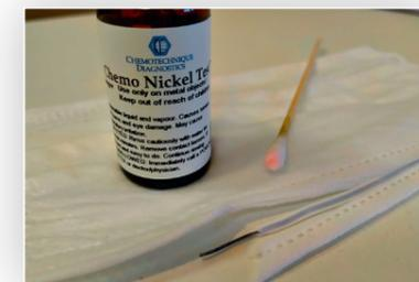
Figure 3. Spot test au nickel confirmant la présence de nickel sur l'embout métallique du masque de la patiente 2.
